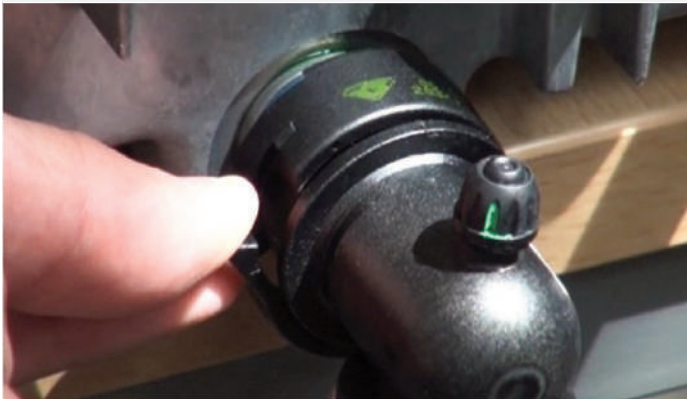
Raccordo tubazione raffreddamento
