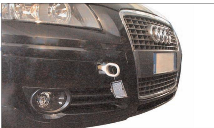
una copertura removibile nella parte inferiore destra del paraurti. Il foro filettato per il gancio posteriore è posizionato nella parte inferiore destra del paraurti posteriore.
