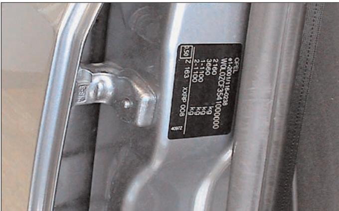
L'importanza dei dati sulla targhetta d'identificazione viene spiegata in seguito. Per il Servizio Assistenza tecnica sono di particolare rilievo il n. d'identificazione veicolo (VIN) sulla riga 3 e il codice colore, rifiniture interne e memoria di programma per il MID (l'ultimo solo a scelta) sulla riga 8.
