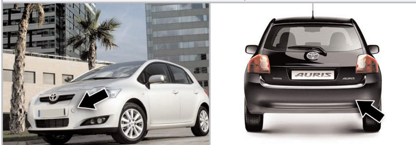
Ubicazione anci di traino anteriore e posteriore
