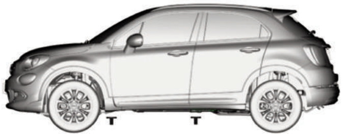
Punti sollevamento con ponte a due colonne
