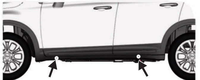
Punti sollevamento con ponte a due colonne
