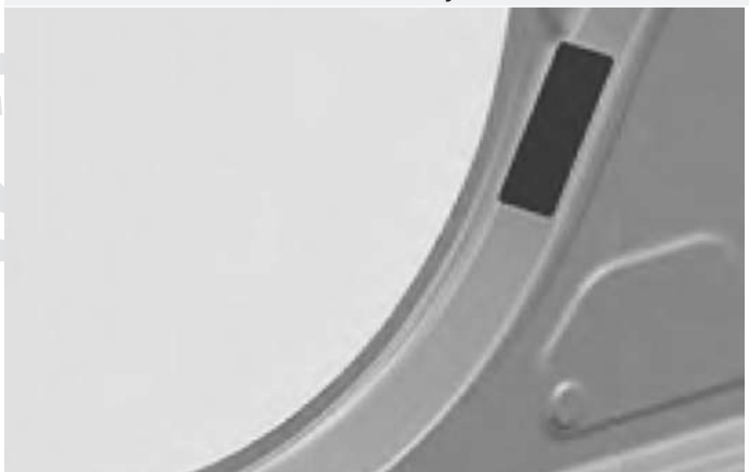
Posizionamento numero identificativo vettura
