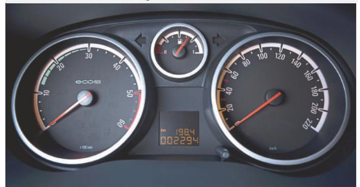
Sul display possono essere visualizzati diversi tipi di codici di ispezione che segnalano il tipo di intervento a cui deve essere sottoposta la vettura.
