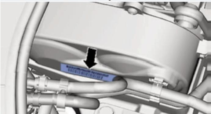
Il numero d'identificazione del motore è composto da una sequenza di max 9 caratteri (alfanumerici). La prima parte (di 3 lettere al massimo) costituisce la "sigla del motore", la seconda parte (di sei cifre) il "numero progressivo". Se sono stati prodotti più di 999.999 motori con la stessa sigla, la prima delle sei cifre viene sostituita con una lettera.
